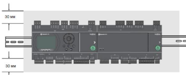
Рисунок 1 Горизонтальная установка устройств SystemePLC SR на DIN-рейку
