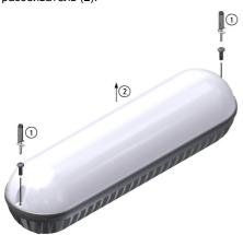
2. Открутить два винта (1) и снять платик / светодиодный кластер (2) (не касаясь и не повреждая светодиодов).
