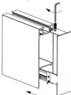
6.3. Закріпити комплект підвісів на опорній поверхні. Встановити кінці тросів в гриппери підвісу в корпусі. Відрегулювати положення світильника.
