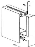
6.3. Закрепить комплект подвесов на опорной поверхности. Установить концы тросиков в грипперы подвеса в корпусе. Отрегулировать положение светильника.
