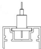
6.2. Установить в корпус торцевые крышки и рассеиватель
