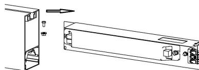
5. Продеть питающий провод через отверстие в корпусе, вывести кабель из профиля наружу. Подключить питающий провод к драйверу в соответствии с указанной полярностью, установить кронштейн с драйвером обратно в корпус.
