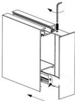
7.3. Используя монтажные отверстия установить корпус светильника на опорную поверхность саморезами.
