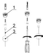
7. Для установки светильников на опорную поверхность:
