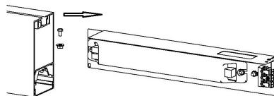
5. Протягнути провід живлення через отвір в корпусі, вивести кабель з профілю назовні. Підключити провід живлення до драйверу відповідно до зазначеної полярності, встановити кронштейн з драйвером назад в корпус.
