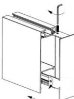
7.3. Використовуючи монтажні отвори встановити корпус світильника на опорну поверхню саморізами.
