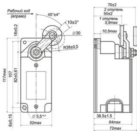
а) с приводом рычаг с роликом
