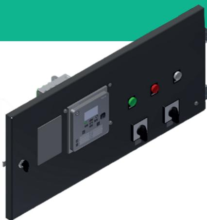
Классический ретрофит предполагает модернизацию шкафа управления ячейки посредством замены устаревшей системы защиты и автоматики, выполненных, как правило, на электромеханических реле, на современные цифровые устройства типа БМРЗ.
