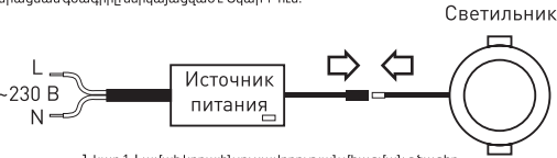
Նկար 1. Լամպի կողային լուսավորության միացման գծագիր
