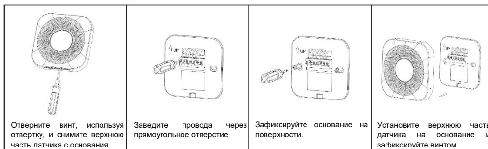
Порядок установки датчика качества воздуха
