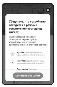
Переведите устройство в режим подключения длительным нажатием на кнопку устройства. Светодиодный индикатор устройства начнет часто мигать. Нажмите кнопку «Светодиод уже мигает»
