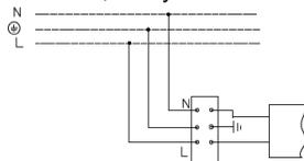
2. Шамдалдың резервтік қуаттандыру блогы бар қуаттандыру желісіне қосылу сызбасы (суретте а - шамдал, b - резервтік қуаттандыру блогы).
