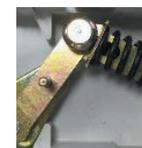
Пружинный механизм расцепления обеспечивает быстрое размыкание, предотвращая сваривание контактов и увеличивая коммутационную износостойкость
