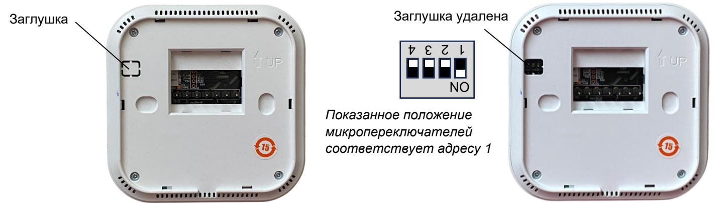
Расположение заглушки и микропереключателей установки адреса
