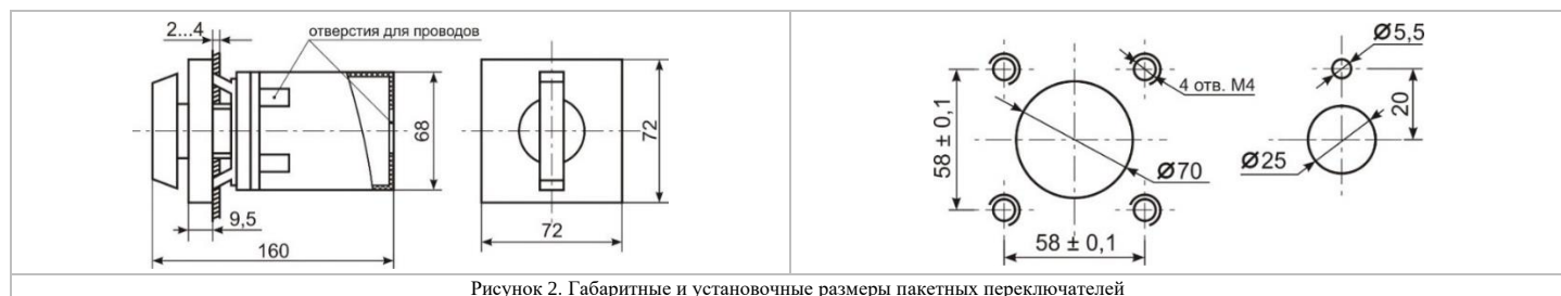
Рисунок 2. Габаритные и установочные размеры пакетных переключателей
