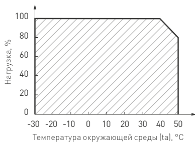
Рис. 2. Максимальная допустимая нагрузка, % от мощности источника
