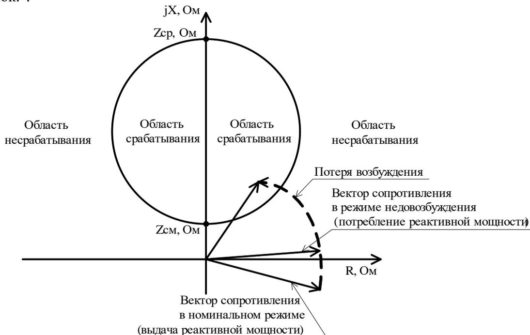
Рисунок 6 - Характеристика защиты от асинхронных режимов
