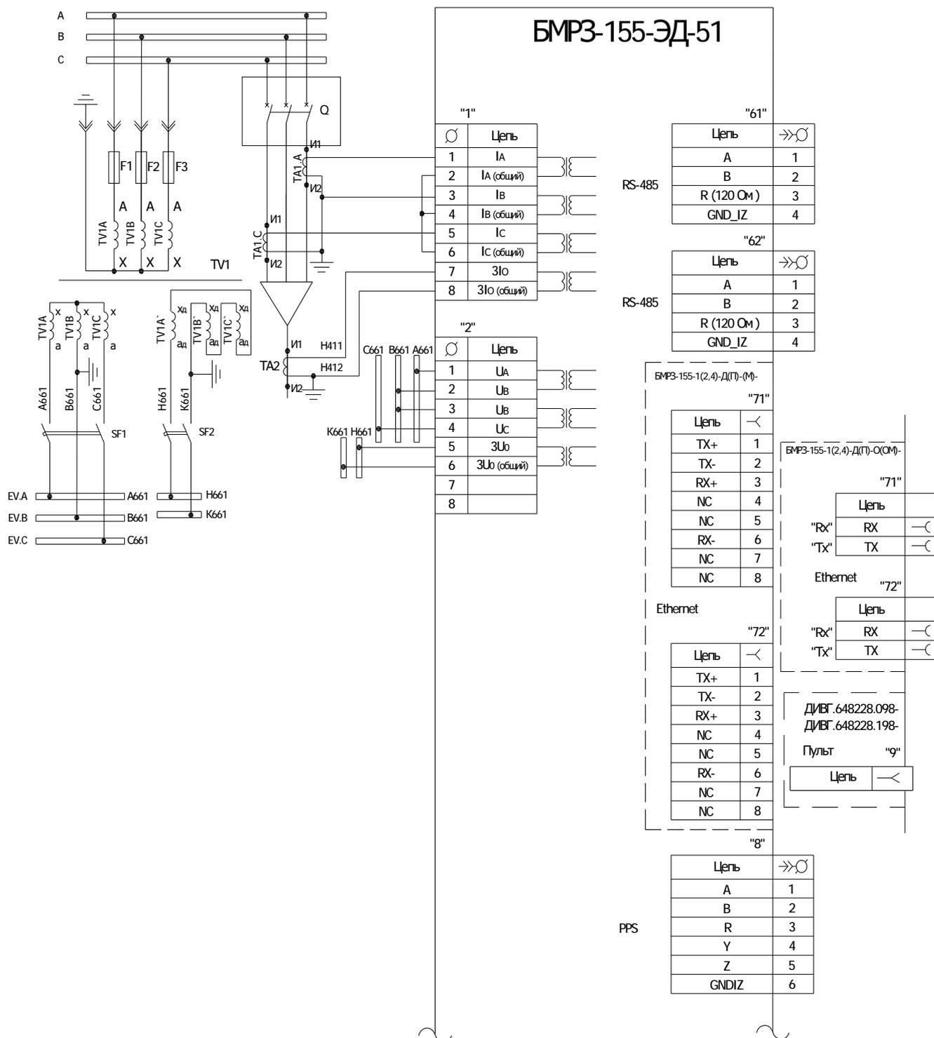
Рисунок А.2 - Схема электрическая подключения (два трансформатора тока)
