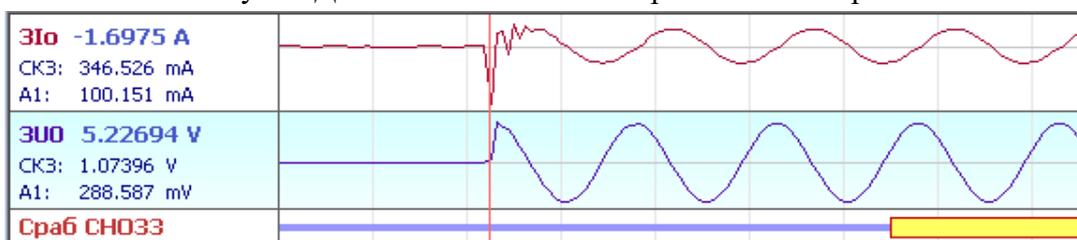
Рисунок Д.2 - Осциллограмма при внутреннем замыкании в точке К1
