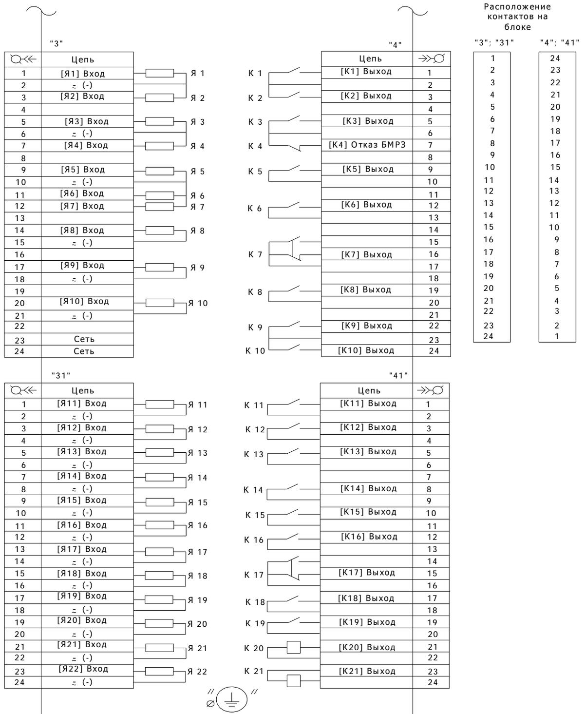
Рисунок А.3 - Схема электрическая подключения БФПО
