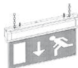
Потолочное крепление на цепь (гибкий подвес ST 50)
