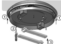
7. Установить рассеиватель и зафиксировать его винтами.
