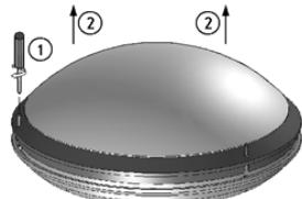
2. Снять отражатель.
