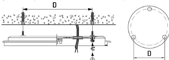
5. Подключить сетевой провод к клеммной колодке в соответствии с указанной полярностью.
