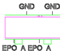
Рис. 6.4.1.2 4-пиновый ЕРО клеммник
