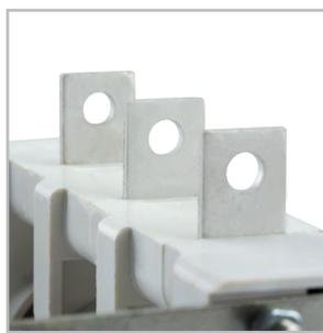
Контактные выводы, выполненные из высококачественной электротехнической меди (ВР32Ф-100А из биметалла) с нанесенным защитным покрытием, позволяют присоединять медные и алюминиевые токопроводящие жилы, оконцованные кабельными наконечниками, а также медные и алюминиевые шины.
