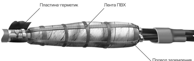
**17.1** Распрямить и вытянуть вдоль монтируемой муфты три провода заземления, закрепленные на кабелях из сшитого полиэтилена, до бронелент кабеля с бумажной маслопропитанной изоляцией. Закрепить их бандажом из 2-3 витков проволоки на облученных поверхностях бронелент.
