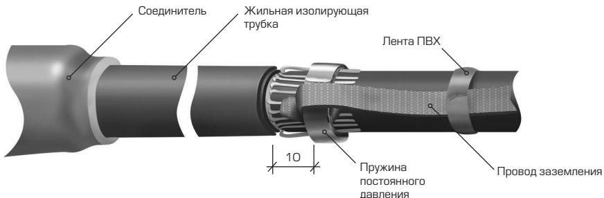
**12.1** Растигнуть в ширину конец провода заземления на длине 90-100 мм.
