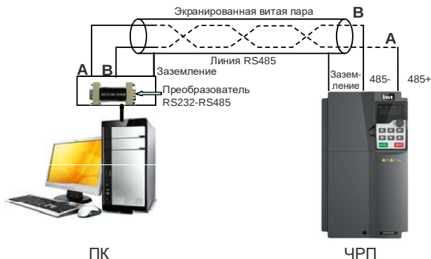
Рисунок 10-1 Схема подключения RS485 для сети с одним ПЧ
