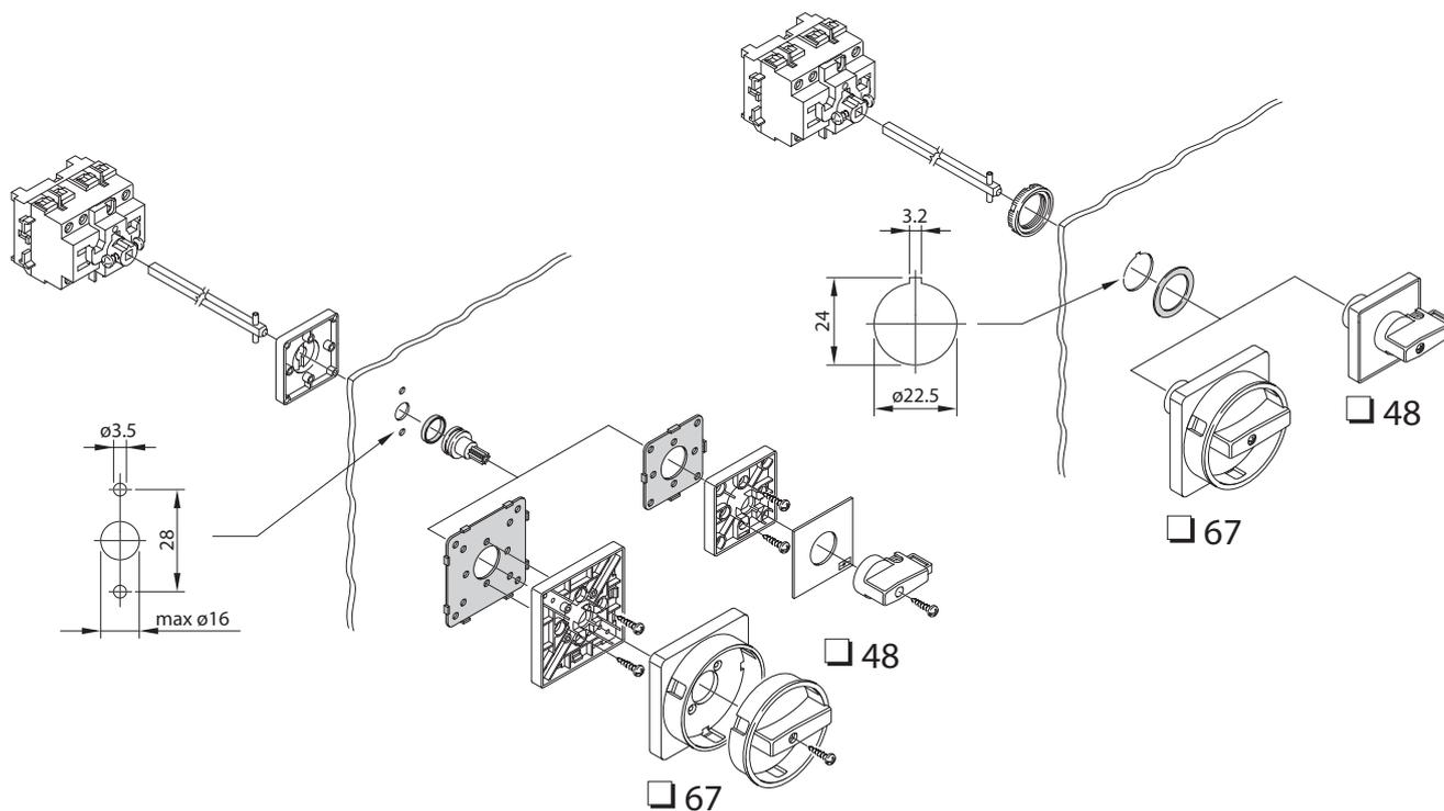
**Схема установки на монтажную плату/DIN-рейку выключателей АЕ63-100**
