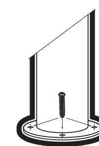
Рис.5 Схема крепления светильников PGB 01-900, PGB 02-900, PGB 03-800 к опорной поверхности
