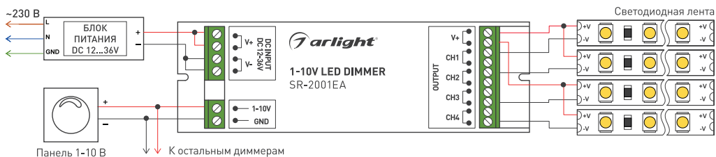
Рис. 2. Схема подключения SR-2001EA.
