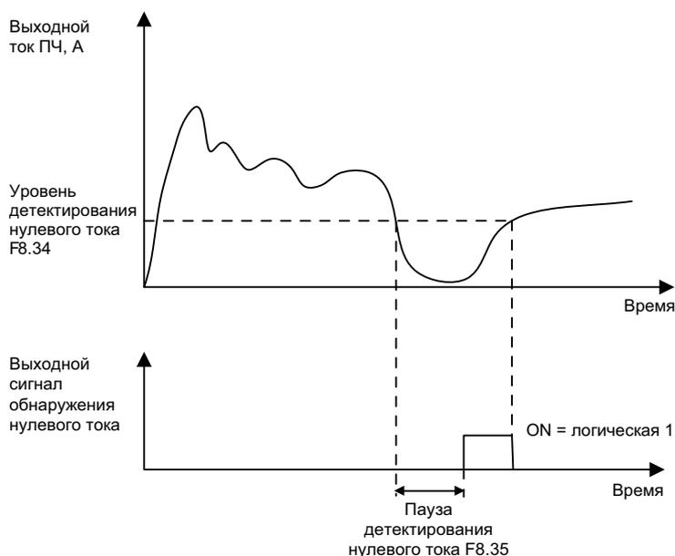
Рисунок 4-20 Логика работы функции обнаружения нулевого тока
