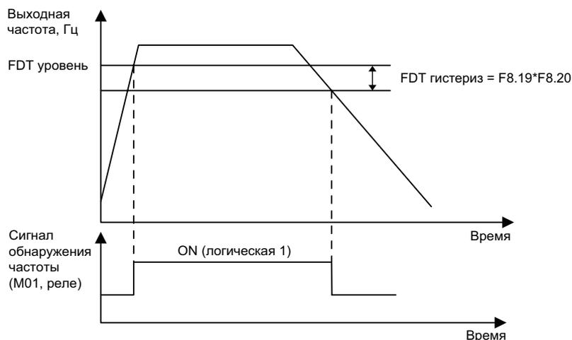
Рисунок 4-15 Логика функции «Достижение уровня частоты FDT1»
