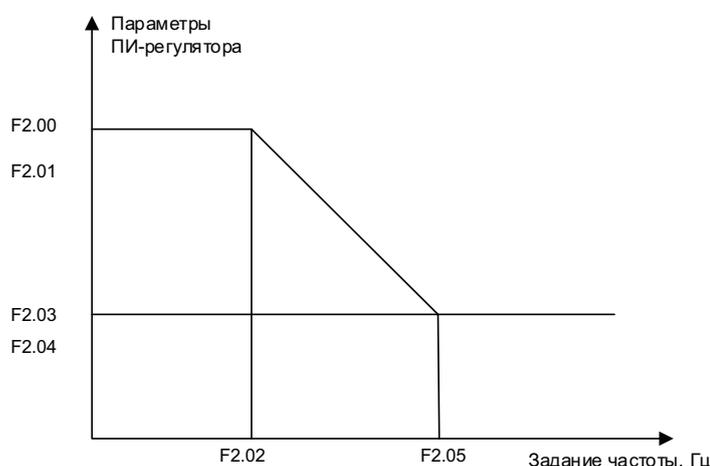
Рисунок 4-1 Интерполяция параметров ПИ-регулятора скорости
