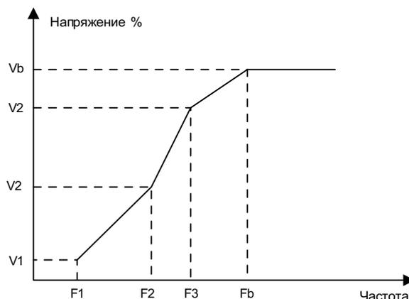
Рисунок 4-3. Схематическая диаграмма настройки многоточечной кривой U/F.
