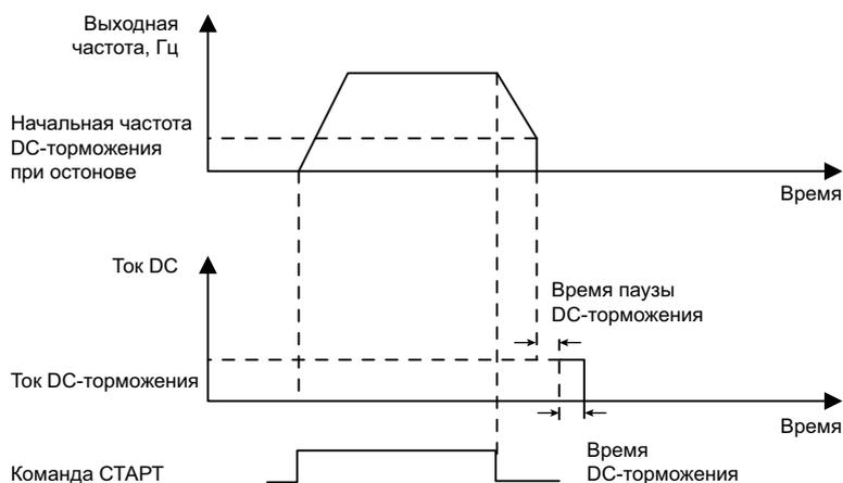
Рисунок 4-12 Диаграмма торможения постоянным током при останове
