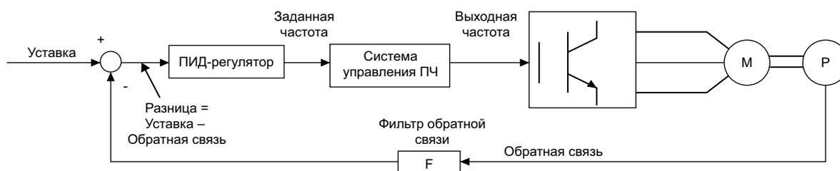
Рисунок 4-24 Блок-схема ПИД-регулирования
