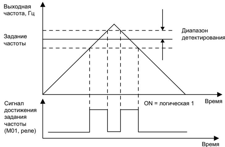
Рисунок 4-16 Логика работы функции «Достижение задания частоты»
