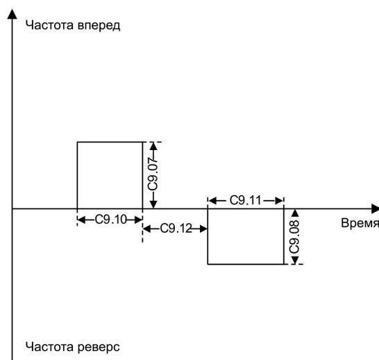
Процесс очистки насоса: двигатель сначала вращается вперед в течение определенного периода времени, затем останавливается на определенный период времени, затем вращается в обратном направлении в течение определенного периода времени и, наконец, снова поворачивается вперед после остановки на определенный период времени и так далее.
