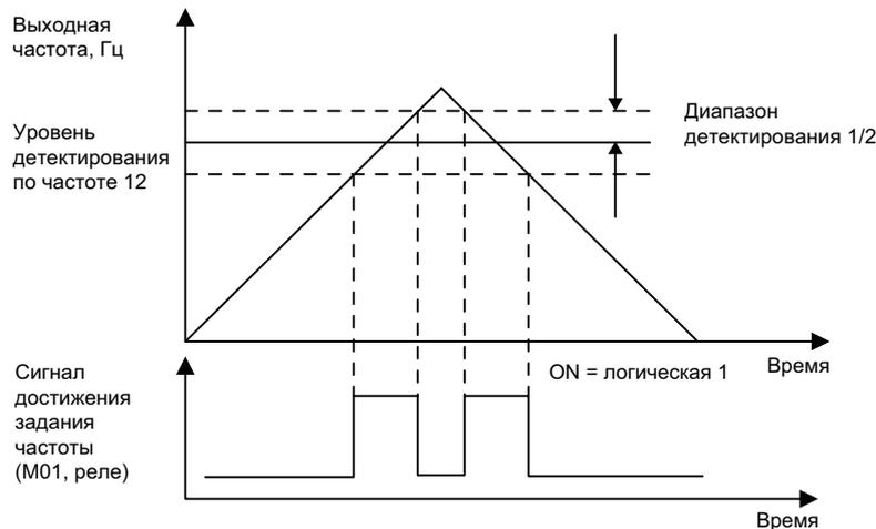
Рисунок 4-19 Логика работы функций 26/27: Достижение уровня частоты 1/ частоты 2
