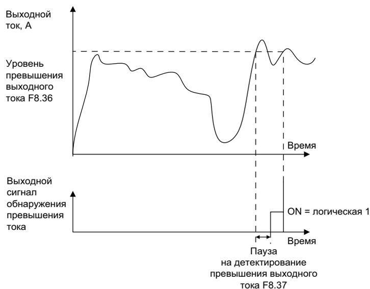
Рисунок 4-21 Схематическая диаграмма обнаружения превышения выходного тока
