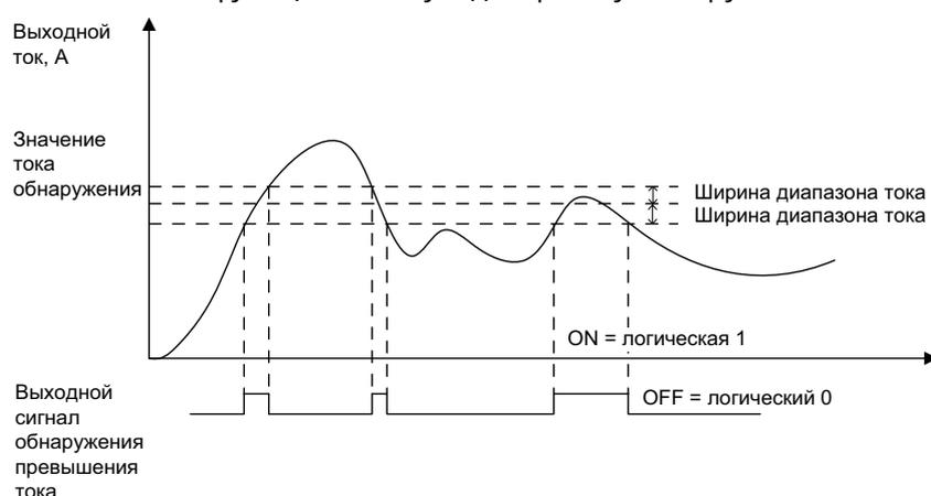
Рисунок 4-22 Схематическая диаграмма обнаружения любого достижения тока.
