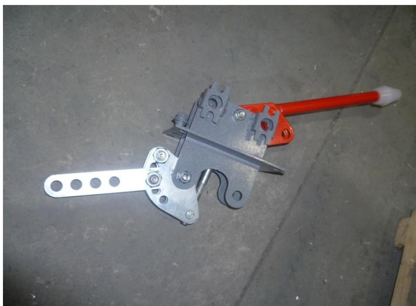
Для сочленения приводов и разъединителя необходимы тяги. Тяги состоят из шпильки, определенного размера, с резьбой М16 и длиной резьбы не менее 50 мм., и вилок показанных на фото ниже.
