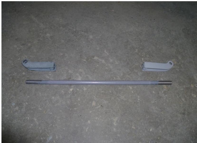
Фото тяги в сборе. Понадобятся две контр-гайки М16.
