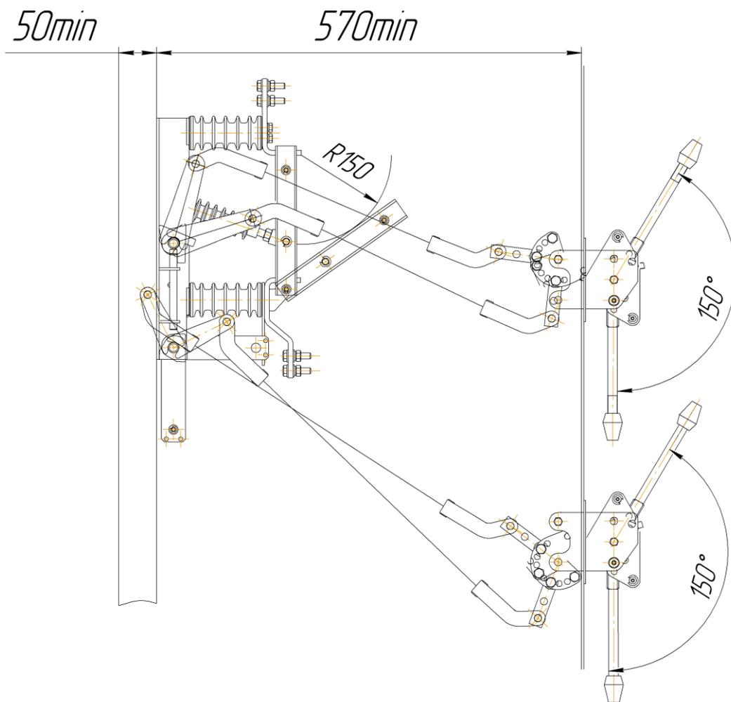
Рис.1 Возможное расположение РВЗ (исп.2) с приводом ПР-10. Промежуточные тяги (показаны тонкой линией) в комплект поставки не входят.
