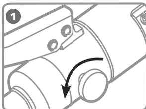
**Поверните винт сброса давления в положение «Открыть».**
