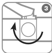
3 Поверните винт в положение «Закреть»
