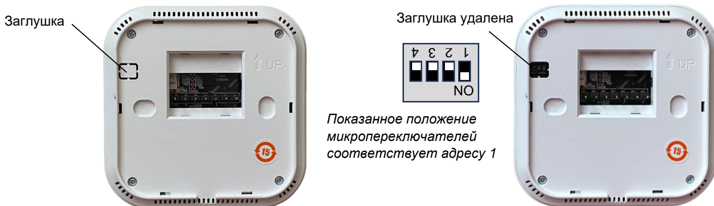
Расположение заглушки и микрпереключателей установки адреса
