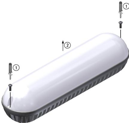
2. Открутить два винта (1) и снять пластик / светодиодный кластер (2).
