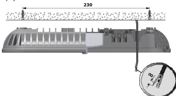
4. Закрепить корпус на поверхности потолка с помощью комплекта крепежа X5 (не входит в комплект поставки), предварительно надев на винты резиновые шайбы (входят в комплект поставки).
