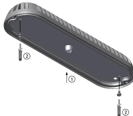
7. Установить обратно на корпус рассеиватель (1) и зафиксировать его винтами (2).
