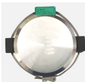
Рис. 5. Пример монтажа датчика температуры с применением двух резиновых прокладок.
