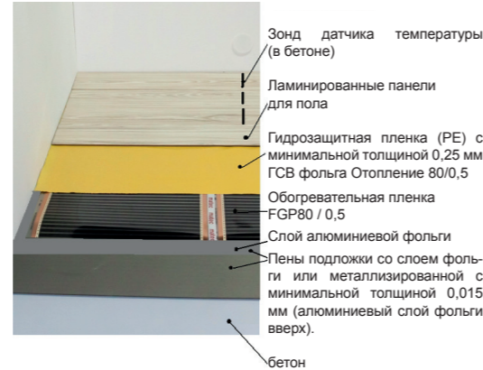
Рис. 3. Слои при монтаже обогревательной пленки
