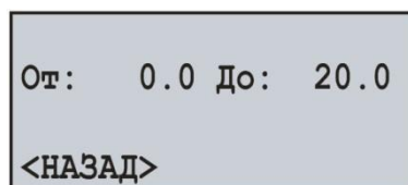
Рисунок 6.9 – Экран настройки масштаба датчика аналогового тока
