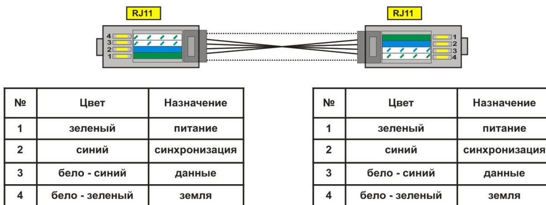
Рисунок 4.2 – Нумерация выводов кабеля КМР-11-1
