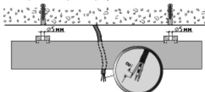
5. Підключити мережевий провід до клемної колодки відповідно до зазначеної полярності.
