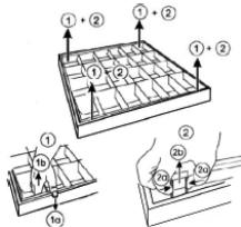
3. Вщелкнуть опоры в корпус светильника.
