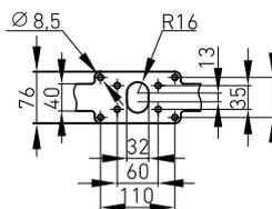
Установочные размеры скобы одинаковы для всех типов корпусов.
