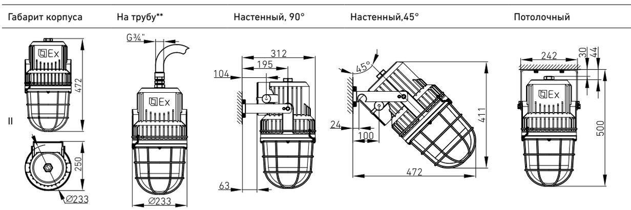
\*\* кроме светильников мощностью 400 Вт
