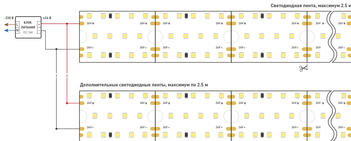
Схема подключения нескольких светодиодных лент с одной стороны.
