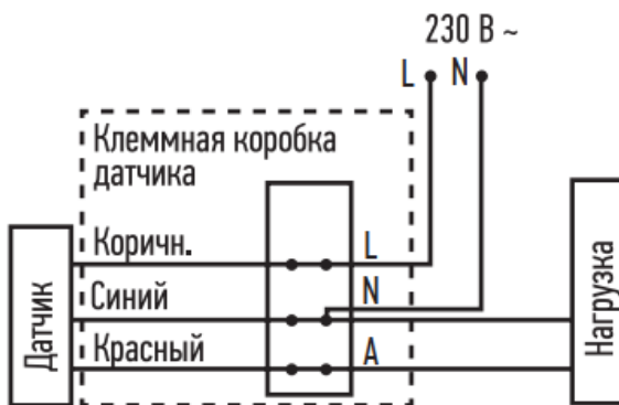
Рисунок 5. Схема подключения датчика движения MD 25
