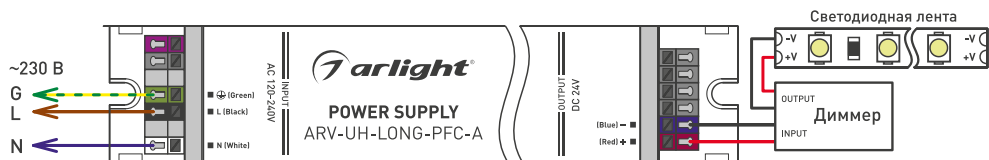
Рис. 2. Схема подключения блока питания к светодиодной ленте через диммер
