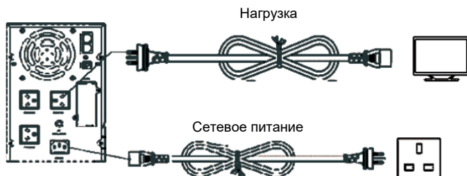
Рисунок 8-2. Подключение ИБП мощностью 1000-3000 кВА
