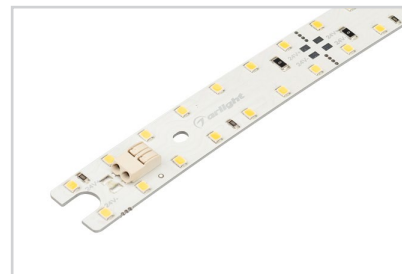
027652 SL-ARC-D3000-A23-11.6W 24V Warm3000 (590мм, дуга 1 из 16)
