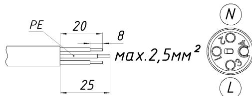
4. Зафиксировать провода винтами, собрать кабельный соединитель в обратной последовательности. Муфты затянуть с усилием 2,5Н·м.
