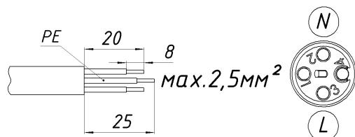
4. Зафіксувати дроти гвинтами, зібрати кабельний з'єднувач в зворотній послідовності. Муфти затягнути із зусиллям 2,5 Н·м.
