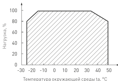
Рис. 2. Максимальная допустимая нагрузка, % от мощности источника.
