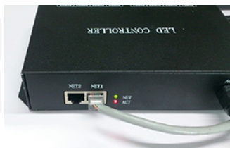
Рис. 2. Подключение контроллера HX-801RC к мастер-контроллеру или компьютеру.
