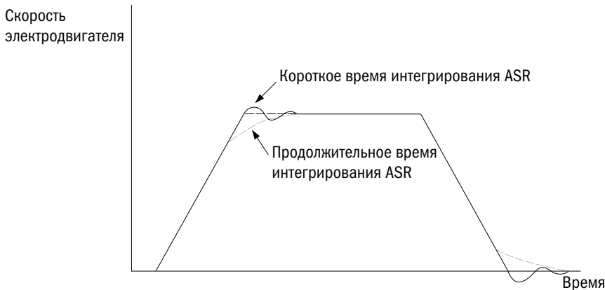
Рисунок 6.27. Отклик для времени интегрирования ASR
