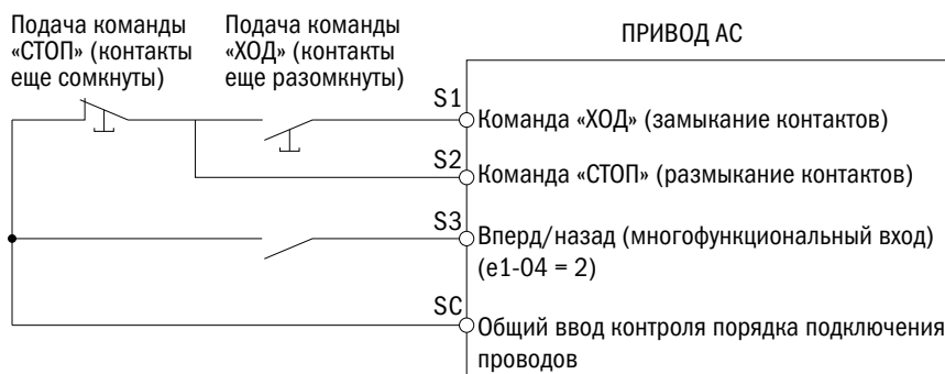
Рисунок 6.44. Схема трехпроводного подключения управлением преобразователя
