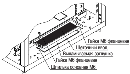
Рисунок 15 – Монтаж щеточного ввода
