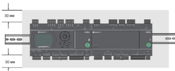
Рисунок 1 Горизонтальная установка устройств SystemePLC SR на DIN-рейку
