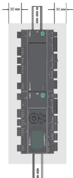
Рисунок 2 Вертикальная установка устройств SystemePLC SR на DIN-рейку
