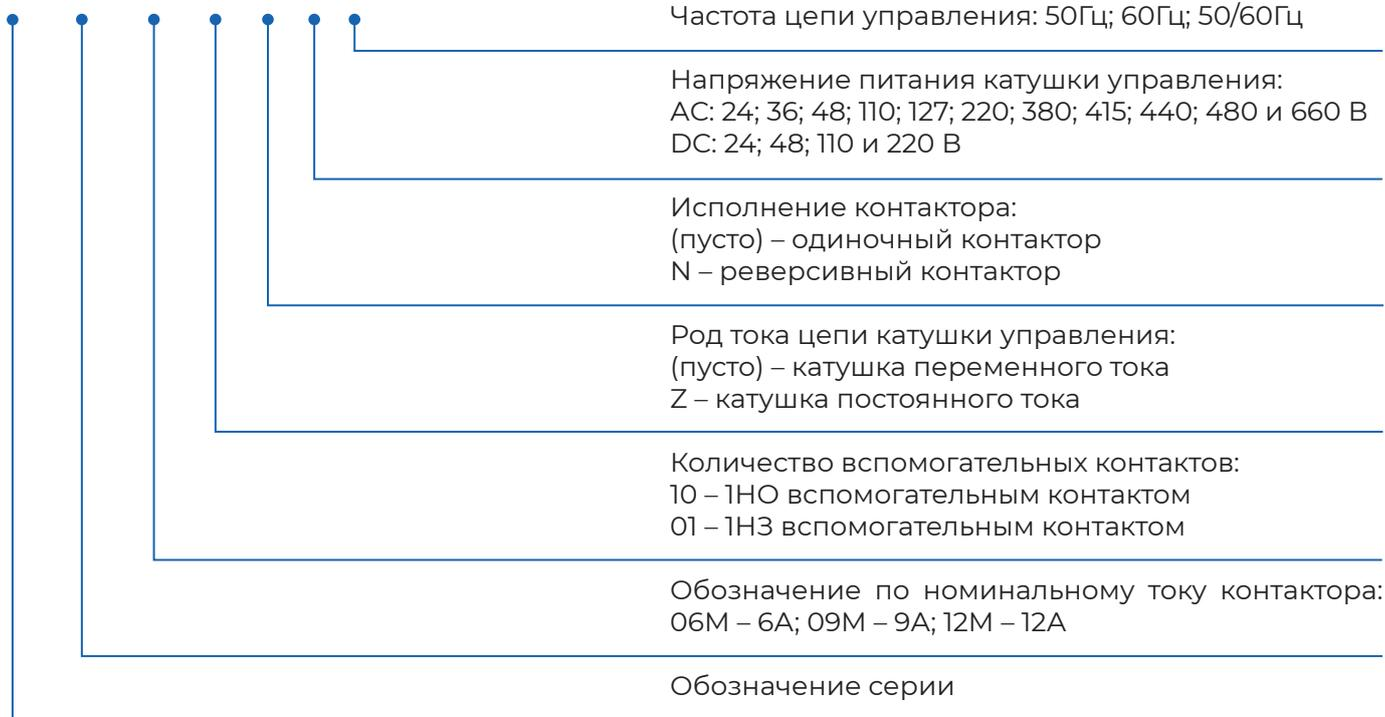
**Примечание.** Контакторы на ток 6–100 А имеют вспомогательные контакты в исполнении 1НО+1НЗ, а контакторы на ток 120–630 А – 2НО+2НЗ.
