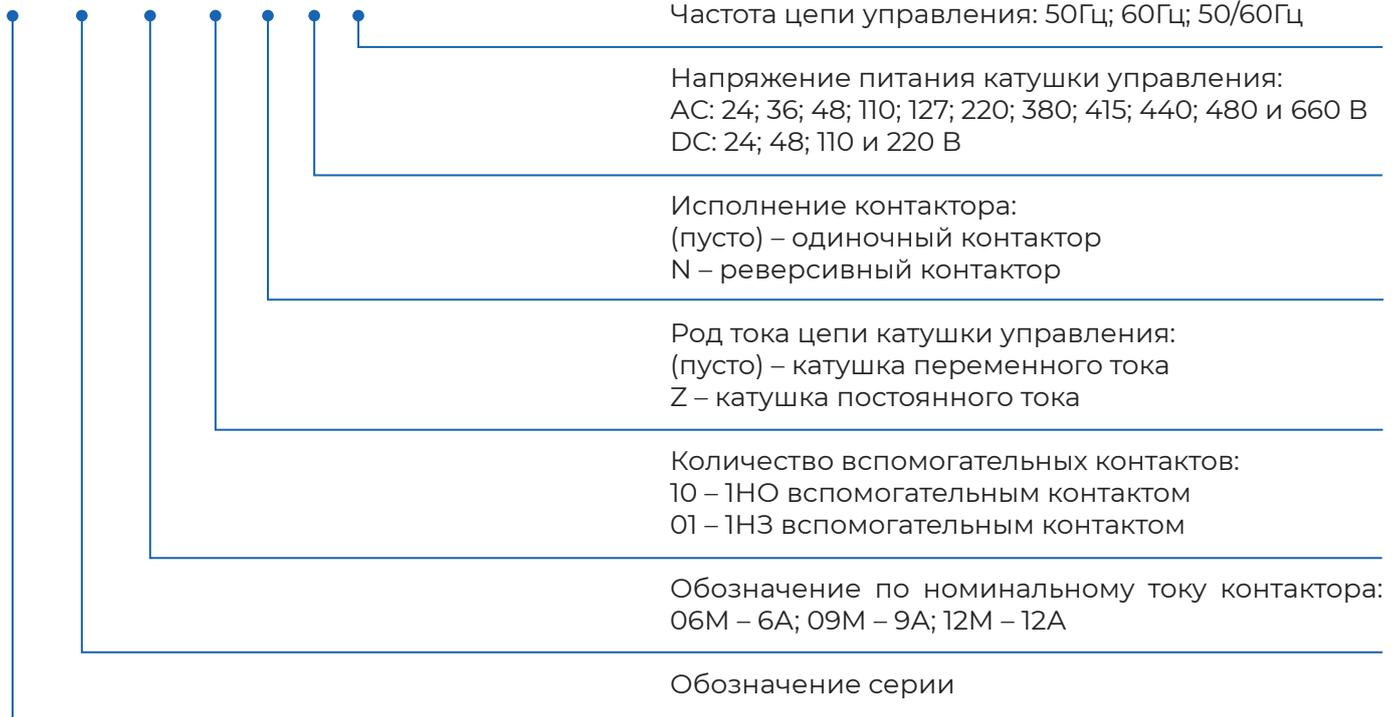
**Примечание.** условное обозначение NXC-12 230В 50Гц – это контактор переменного тока категории применения AC-3, с номинальным током 12 А при напряжении главной цепи 380/400 В; вспомогательные контакты: 1НО+1 НЗ; напряжение и частота катушки управления — AC230 В и 50Гц.
