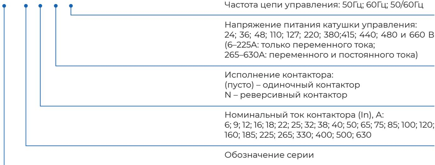
**Примечание.** Контакторы на ток 6–100 А имеют вспомогательные контакты в исполнении 1НО+1НЗ, а контакторы на ток 120–630 А – 2НО+2НЗ.
