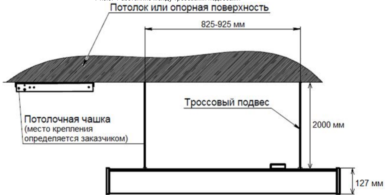
Рис.3. Расстояние между тросовыми подвесами
