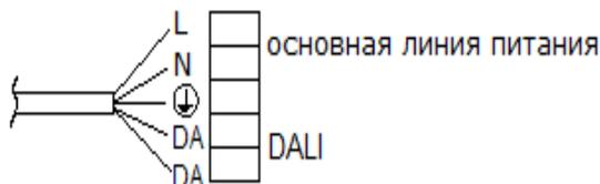
Рис. 1. Схема подключения светильника с управлением по протоколу DALI.
