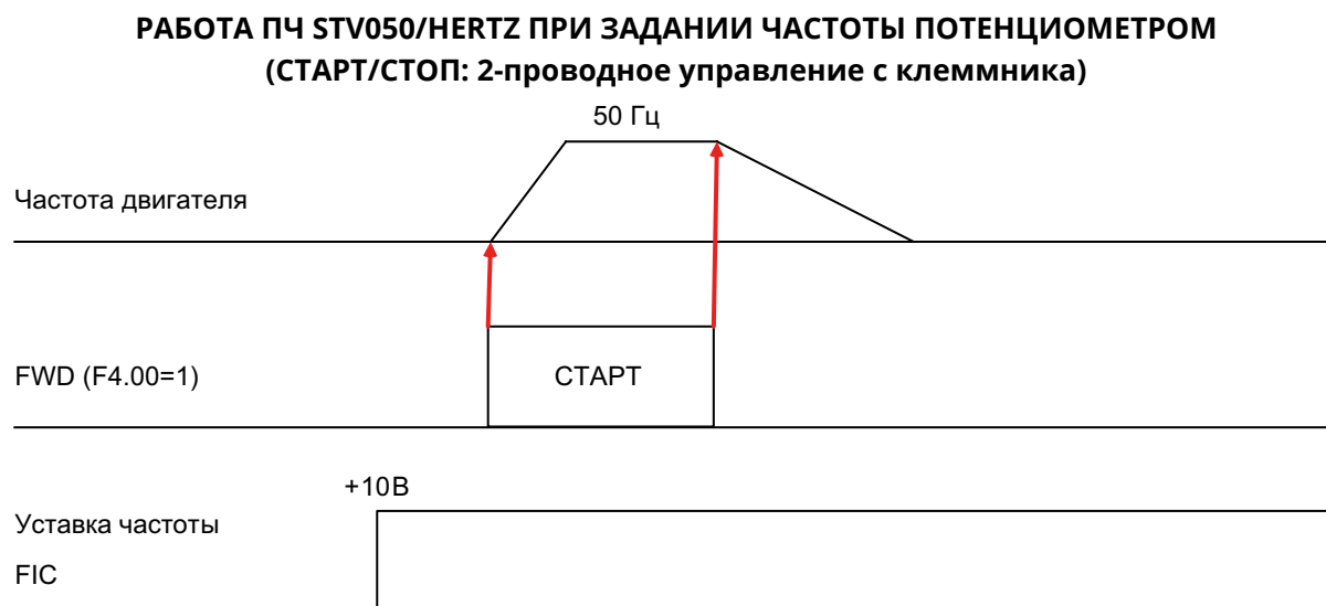
Рис. 4 Осциллограмма работы в режиме 2-проводного управления при задании частоты от потенциометра
