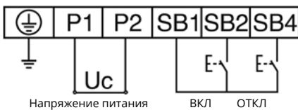
Схема подключения мотор-редуктора
