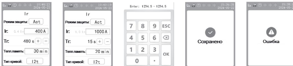
Параметры настройки защиты от перегрузки с большой выдержкой времени
